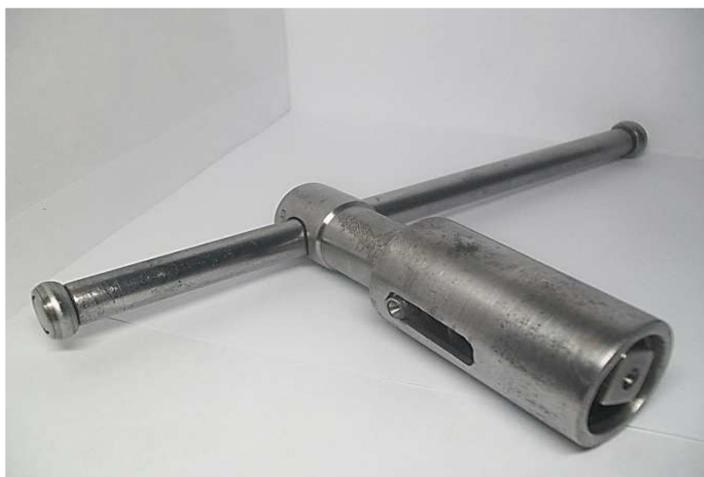
**Актуальность темы.** Специальный ключ исключает возможность травматизма при закреплении заготовок в патроне токарного станка
